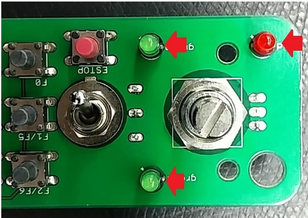
Anschließend können die Taster bündig eingelötet werden.
