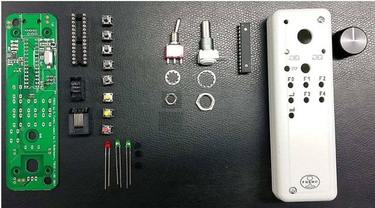
Auf der TOP-Seite der Leiterplatte werden die IC-Fassung, der Wannenstecker und die Loconet-Buchse montiert. Beim Einlöten der IC-Fassung und des Wannensteckers auf die Markierungen auf der Platine und den Kerben in den Bauteilen achten. Danach kann die Loconet-Buchse eingelötet werden.
